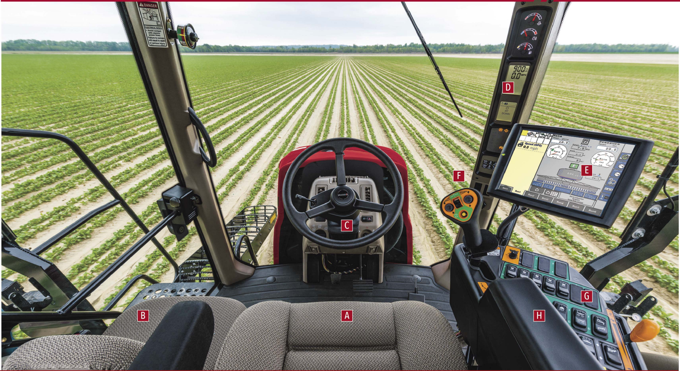
A - Asiento Air-Ride, B - Asiento instructivo, C - Columna de dirección inclinable y telescópica, D - Poste con medidores y lecturas, E - Pantalla AFS Pro 700, F - Palanca de control hidrostático, G - Consola de control derecha, H - Ajuste de la vía de la rueda (debajo de la cubierta del reposabrazos)
